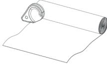
Öppna apparaten och ta ur påskniven. Dra ut passande längd på plasten och dra påskniven längs påsen enligt bilden. Anpassa längden så att det är minst 7 cm mellan påsens innehåll och vakuumpåsens öppning. Använd endast rullplast från OBH Nordica.
