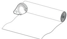
Åpne apparatet og ta ut posekniven. Dra ut passende lengde på plasten og dra posekniven langs med posen som vist på bildet. Tilpass lengden slik at det er minst 7 cm mellom posens innhold og vakuumposens åpning. Bruk kun plastruller fra OBH Nordica.
